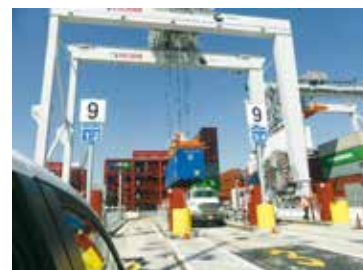
Kalmar社のAutomated Stacking Crane。トレーラからコンテナを吊り上げる様子(ロサンゼルス港TraPacターミナル)
