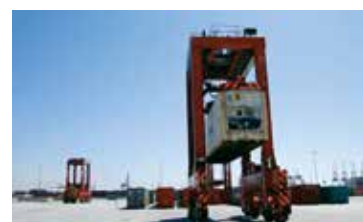
Kalmar社のAutomated Straddle Carrier。ガントリークレーンが降ろしたコンテナを自動的に積み取り運搬する。(ロサンゼルス港TraPacターミナル)
