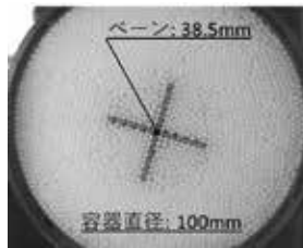
図1 レオメーターによる粘性測定。ベーンが回転し、抵抗を測定する
