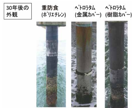
外観、被覆下の鋼材ともに顕著な変状は見られない →30年程度以上の耐久性を有する。
