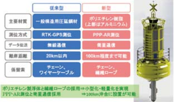
図-1.1.1.4 新型 GPS 海洋ブイの実験機的主要特徴
