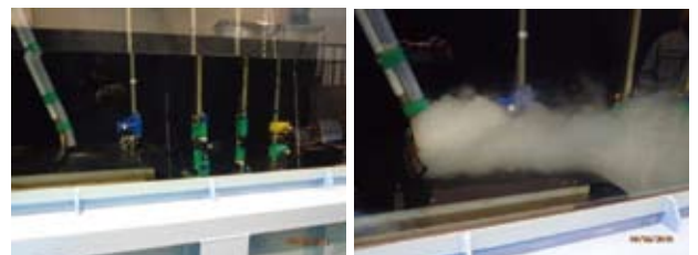
写真-1.1.2.1 河口部での濁水挙動の把握を目的とした水槽実験
