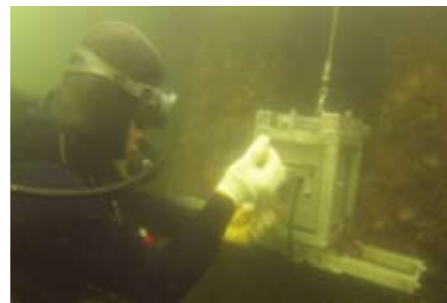
写真-1.1.1.16 潜水士による肉厚測定（現地試験）
