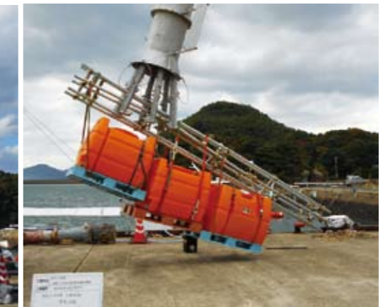
写真 -1.1.1.3 陸上実験（1ton 荷重試験）
