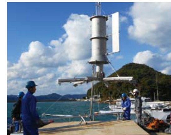
写真 -1.1.1.2 海底ごみ回収装置（実海域試験装置）
