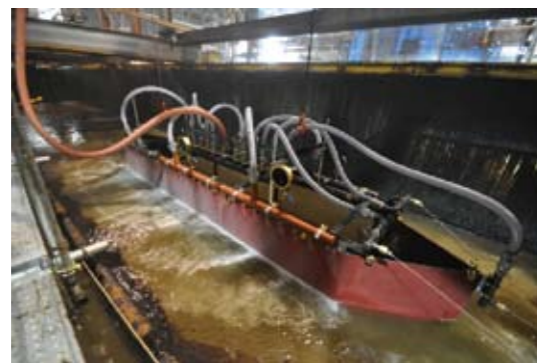
写真 -1.1.1.1 油回収船模型の防汚総合試験
