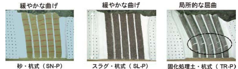
杭式改良地盤の変形・破壊挙動に関する遠心模型実験
