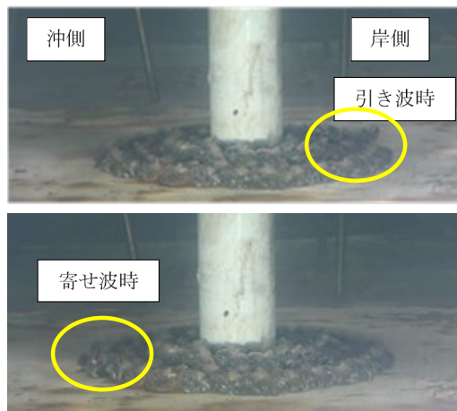
写真-2.2 袋型根固材の挙動の例 ( h=33 m, T_{1/3}=16 s, D=6 m, v=1.5 m/s)
